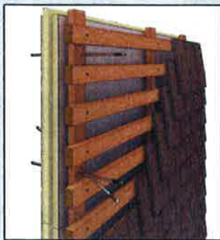
Voorbeeld van voorgevelafwerking scheidsmuur bevestigd op de eigen geïsoleerde draagconstructie als alternatief voor paramentafwerking staand op aanpalende perceel.
