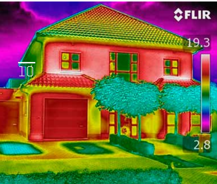
WVI beschikt over een eigen 'thermocam' voor straatthermografie. Daarmee worden inwoners warm gemaakt voor energierenovatie.
