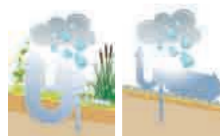
Aandeel infiltratie-afvoer-verdamping van hemelwater bij niet-verharde en verharde oppervlaktes (Waterwegwijzer bouwen en verbouwen, VMM, 2010, www.vmm.be)
